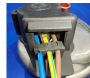
5、胶盖安装 (对齐密封塞胶盖卡槽)
