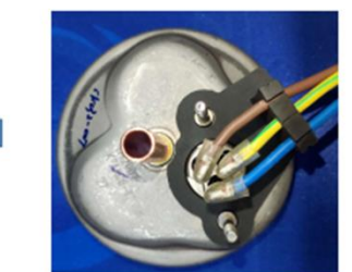
4、端子安装&密封塞定位 (定位槽对齐垫片定位凸起)
